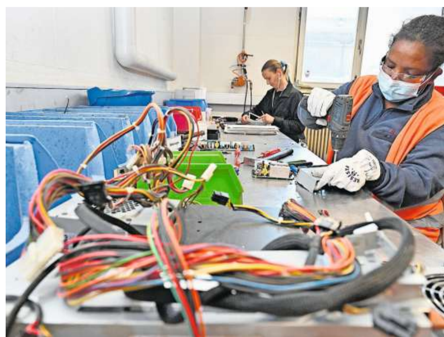
Beschäftigte der Oltech zerlegen die Elektrogeräte in Handarbeit.
